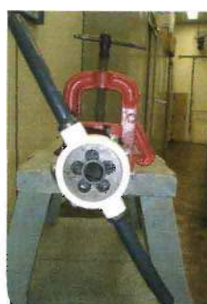
Girar a tarraxa no sentido horário com movimentos para a esquerda e para a direita.
