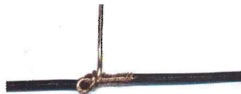
Emenda em prolongamento com condutores rígidos e flexíveis.
