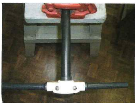
Colocar a tarraxa a 90° em relação ao eletroduto. O lado chanfrado do cossinete deve ficar voltado para o lado do guia.
