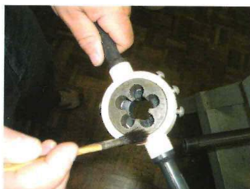
Remover a tarraxa e limpá-la com auxílio de um pincel. Não soprar.
