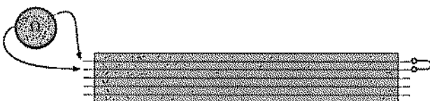
Fig. 3.35 Identificando os fios de um cabo.
