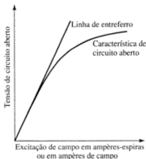
FIGURA 4.37 Curva característica de circuito aberto típica e linha de entreferro.
