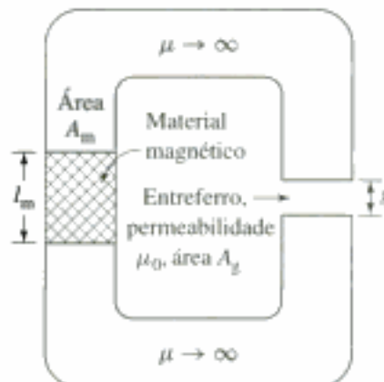
FIGURA 1.17 Circuito magnético do Exemplo 1.9.
