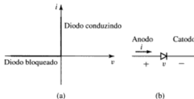
FIGURA 10.2 (a) Característica v \times i de um diodo ideal.
