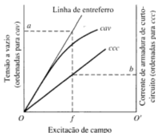
FIGURA 5.7 Características a vazio e de curto-circuito uma máquina síncrona.
