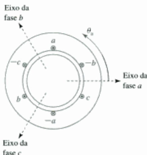
FIGURA 4.29 Enrolamento de estator trifásico simplificado de dois pólos.
