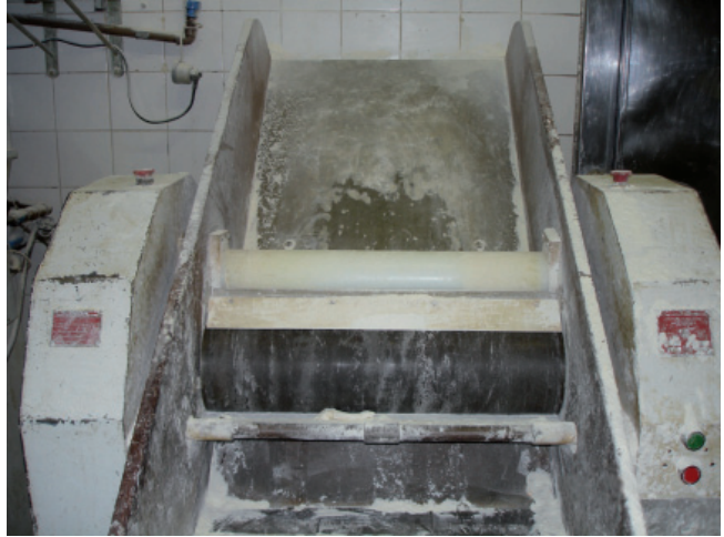
Figura 18.2 Aspecto do cilindro para preparo de massa. Nesse equipamento já existe o acessório de proteção e botão liga e desliga que dificulta a ocorrência de acidentes.
