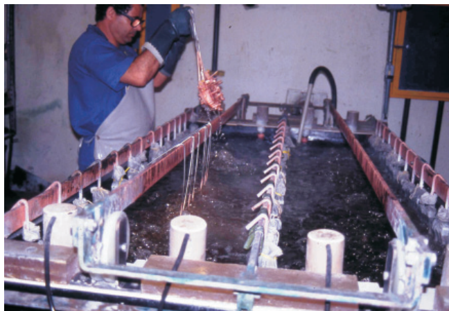
Figura 10.1 Tanque de cobreção. Notar que o trabalhador usa luva de PVC com o cano dobrado. Isto pode evitar que o líquido do banho, que desce pela luva, possa atingir a pele do seu antebraço causando lesões.
