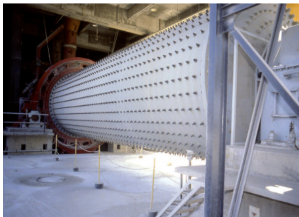
Figura 4.2 Moinho de bolas. O clínquer é moído no moinho de bolas e reduzido a fino material particulado – cimento em pó.
