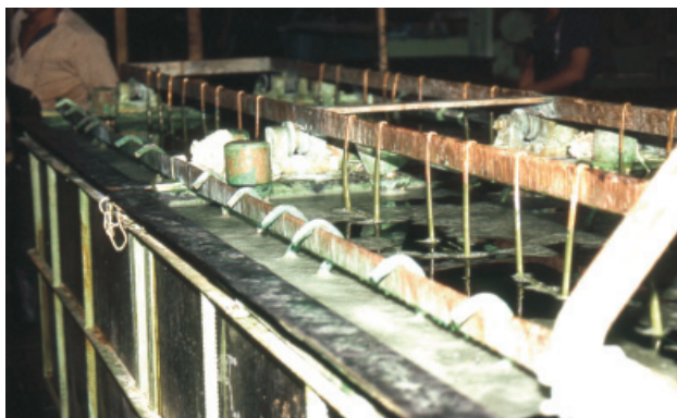
Figura 8.1 Tanque de niquelação. Observe as barras centrais e laterais, onde são colocadas as “gancheiras” para que as peças nelas fixadas sejam niqueladas após a passagem da corrente elétrica. Obs.: estas gancheiras são colocadas e retiradas manualmente, havendo risco do contato frequente com o banho. Existe, ainda, a possibilidade de contato da região abdominal do trabalhador com a borda umedecida do tanque.
