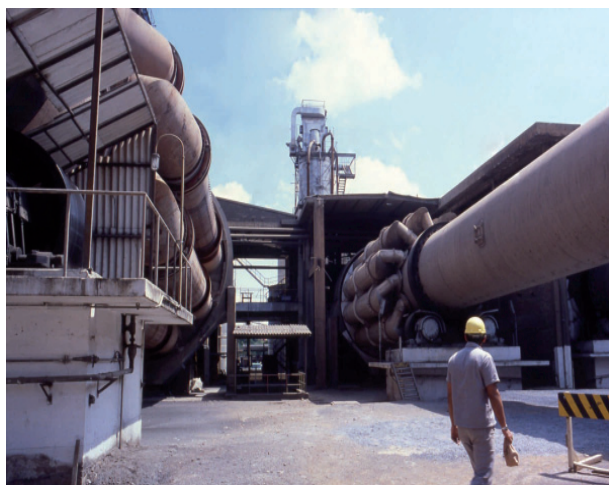
Figura 4.1 Forno tubular onde se faz a queima do clínquer (mistura de calcário + argila + gesso). A temperatura de queima ultrapassa 1.400° C.
