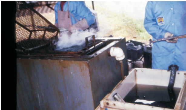
Figura 10.3 Processo de deposição de estanho pelo mergulho de peças em tanque contendo estanho derretido. Neste processo, fumos de estanho atingem as vias aéreas e a pele do trabalhador. Pode ocorrer febre dos fumos metálicos. Neste caso em particular, ocorrem lesões acneiformes nas áreas de penetração dos fumos no vestuário, atingindo ombros, região mentoniana inferior e pescoço.
