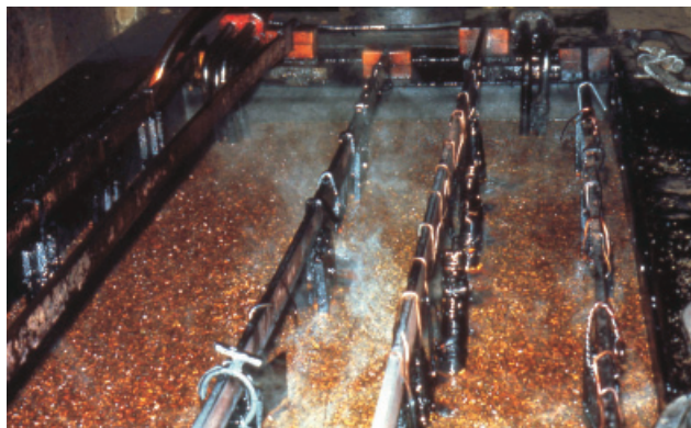
Figura 9.1 Tanque de cromação aberto. Não há ventilação exaustora nas bordas do tanque. Névoas emanadas no processo de cromação podem atingir as vias aéreas superiores e causar perfuração no septo nasal em trabalhadores susceptíveis. Foto cedida pelo professor Luiz Carlos Morrone.
