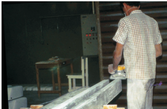
Figura 13.1 Processo de lixamento de mantas de fibra de vidro coladas com resinas. Neste processo, fragmentos da fibra podem ser inalados e depositados no vestuário e na pele desprotegida.
