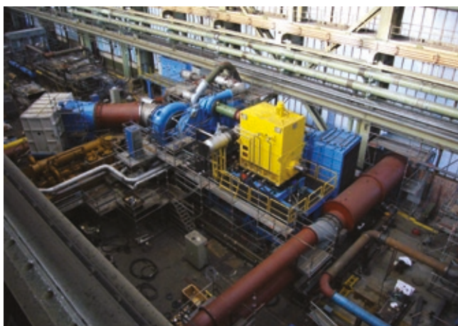
Fornecimento: 14.000 kW, 10.000 V, 4 polos, IC86W Aplicação: Laboratório de teste
