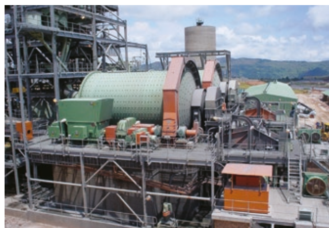
Fornecimento: 6.500 kW, 11.000 V, 6 polos, IC611 Aplicação: Moinho de bolas
