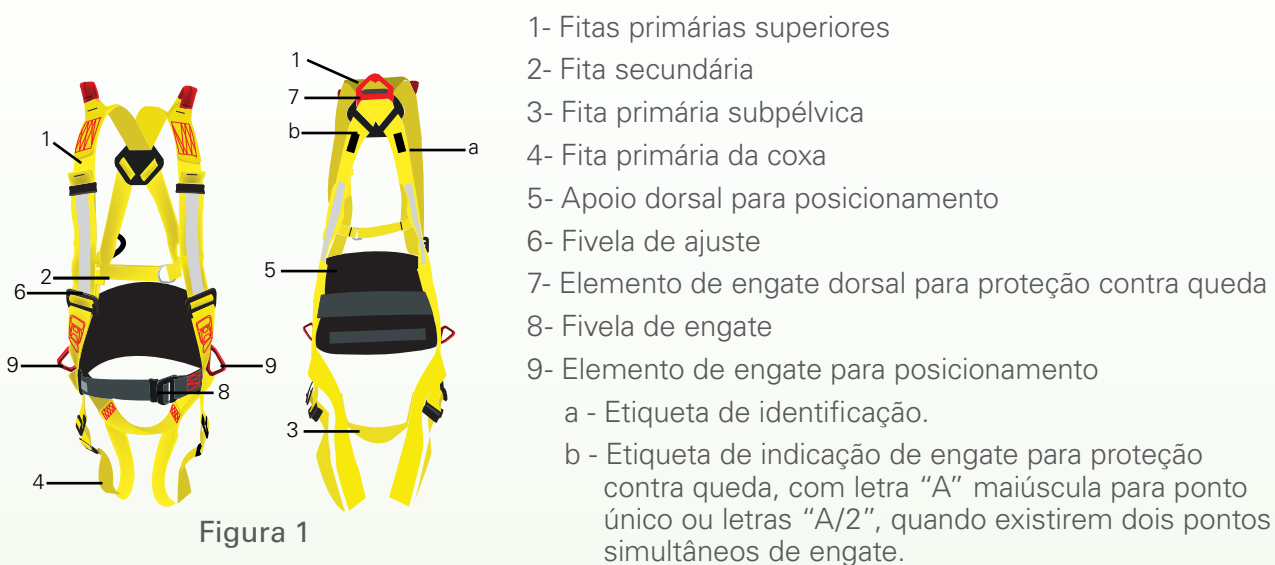
Figura 1 - Exemplo de cinturão de segurança tipo paraquedista com elemento de engate para proteção contra quedas dorsal e elemento de engate para posicionamento
