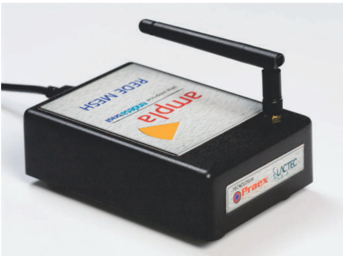
Figura 8. Dispositivo coordenador/concentrador e Sistema de Gerenciamento de Rede Mesh.
