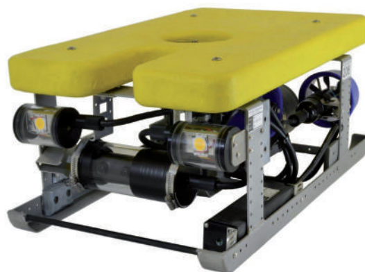
Figura 2. Imagem do Outland Robô 1000, no qual é possível se observar o sistema frontal de iluminação e de câmeras de vídeo.
