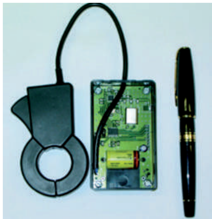
Figura 2: Foto do medidor completo, com o minialicate e o circuito alojado em sua embalagem final.
