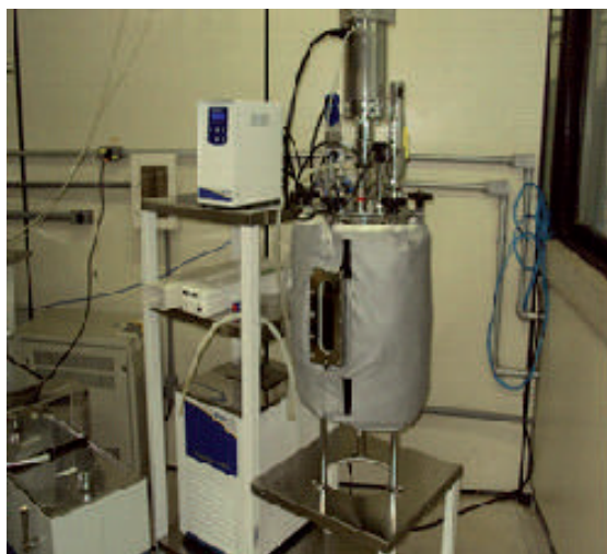
Figura 1: Reator anaeróbico em aço para os processos de biodigestão.
