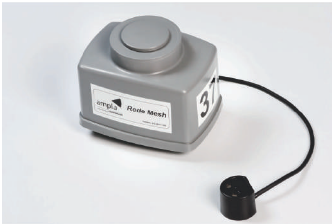
Figura 6. Dispositivos end device para leitura de medidores grupo A e super-visão de equipamentos DNP 3.0, respectivamente.
