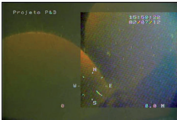
Figura 5. Imagem de um hélice, com a janela de processamento do módulo Lynn posicionada à direita, mostrando a sensível melhora de nitidez da imagem.
