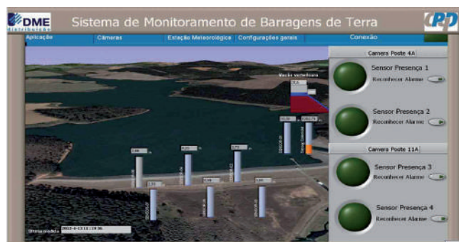
Figura 11. Tela principal do software do sistema de monitoramento de barragens de terra.
