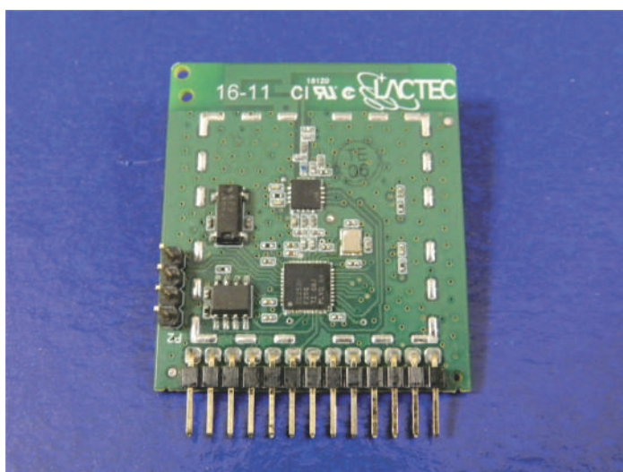
Figura 4. Circuitos eletrônicos do Roteador para Rede Mesh desenvolvidos.
