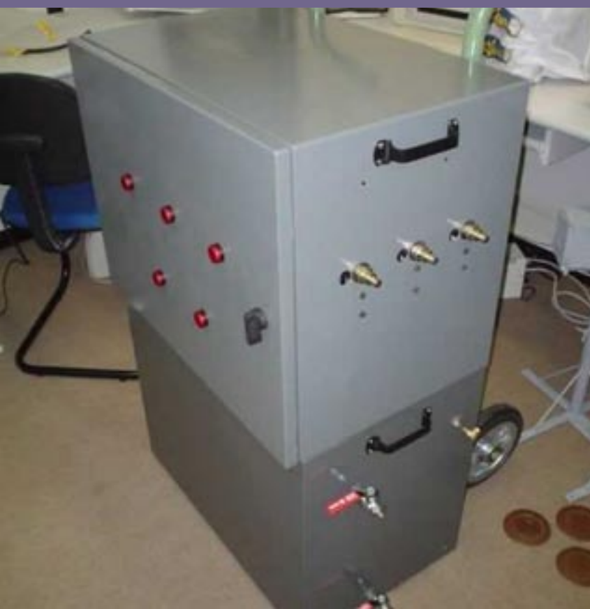
À esquerda, imagem do Múltiplo Analisador de Gás em Óleo (Mago). Abaixo, detalhes de seu interior.
