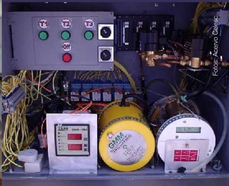
À esquerda, imagem do Múltiplo Analisador de Gás em Óleo (Mago). Abaixo, detalhes de seu interior.
