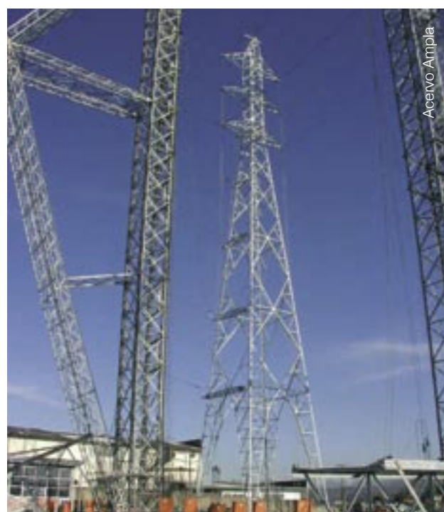
Modelo reduzido de torre de transmissão
